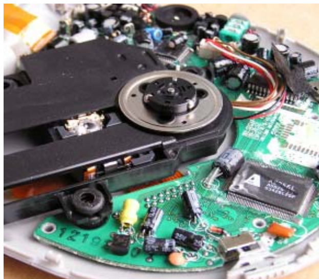
IC-kretsen th sköter bl.a. D/A omvandlingen. Bitströmmen kommer i serieform från laserdioden. Bilden visar en bärbar cd.
