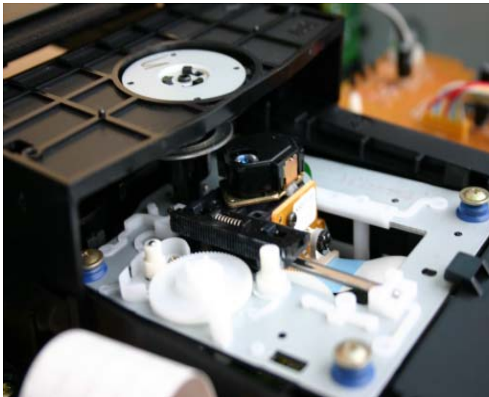
Bild av innanmätet av en cd-spelare. Lasern med sin lins syns i mitten på bilden. Den sitter på en släde som styrs av en motor och ett antal kugghjul av nylon som syns i den vänstra delen.
