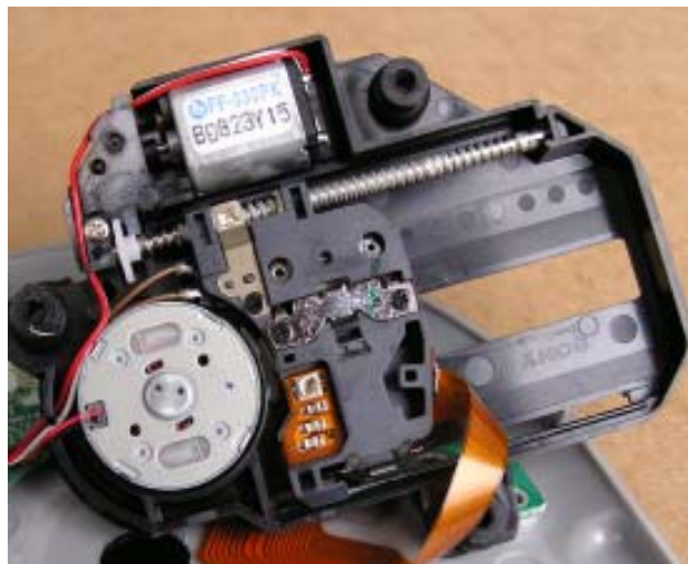
Här ses motorn som roterar cd-skivan nere till vänster och den motor som flyttar släden via ett snäckdrev uppe i bild. Allt är mycket kompakt uppbyggt.
