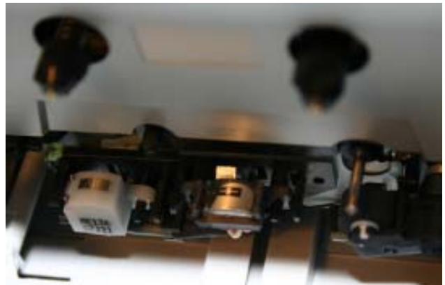
Kassettbandspelaren klarar audiosignaler, dvs upp till c:a 16 kHz. Sedan blir det stopp som följd av för låg bandhastighet.
