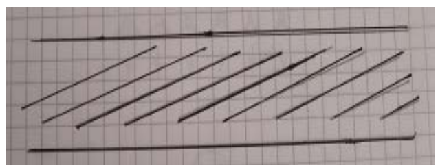
Så här lagras informationen på det breda videobandet. Den ligger snett relativt bandets längdriktning. På så sätt kan man spela bandet långsamt, men ett roterande huvud gör att man kan spela in frekvenser upp till flera MHz..
