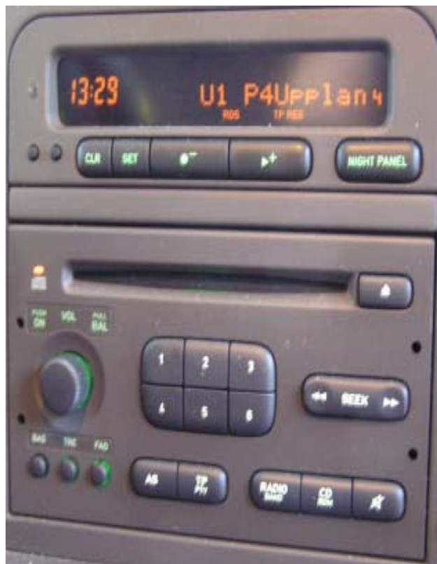
Bilradio med RDS (Radio Data System) Digital frekvensvisning samt info om inställd station visas. När man kör bilen tas automatiskt bästa sändare av inställd programtyp in, t.ex. P4
