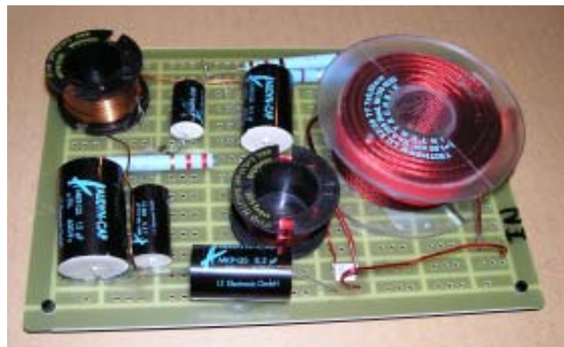
Högklassigt delningsfilter monterat på ett kretskort. Notera stora dimensioner på spolar och kondensatorer.
