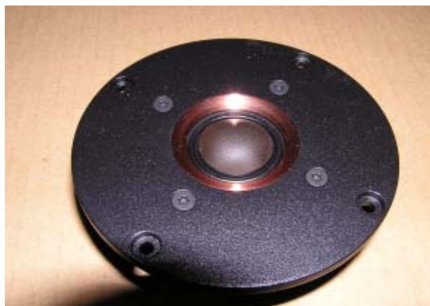
Diskanthögtalare. Lägg märke till den lilla sfäriska konen. Magneten och talspolen sitter på baksidan av frontplattan.
