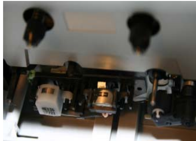
Bild på kassetbandspelare med kombinerat in/avspelningshuvud. Huvudet till vänster raderar och förbereder bandet vid inspelning.
