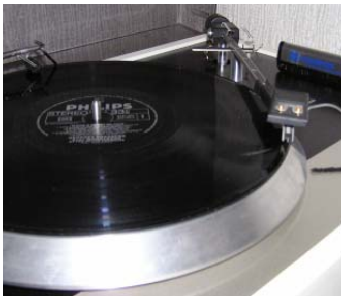
På en LP skiva är ljudet lagrat i form av svängningar fram och åter i ett spår. Det hela ser ut som ett dike i genomskärning. Ju starkare ljud som är inspelat desto större svängningar i skivspåret. Pickupen, som sitter på tonarmen t.h. har en nål av diament som känner variationerna i spåret, och dessa överförs till en elektrisk signal.
