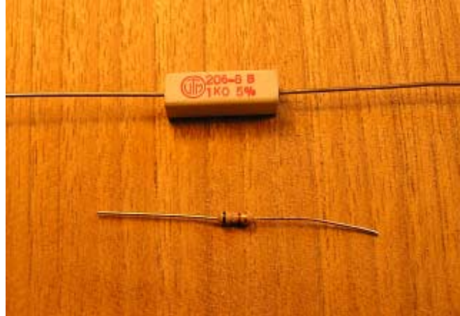
Ett effektmotstånd som tål 4W och ett "standardmotstånd" som bara tål 1/4 - 1/2 W.
