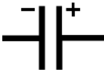
Kondensator med laddning. Likspänning
