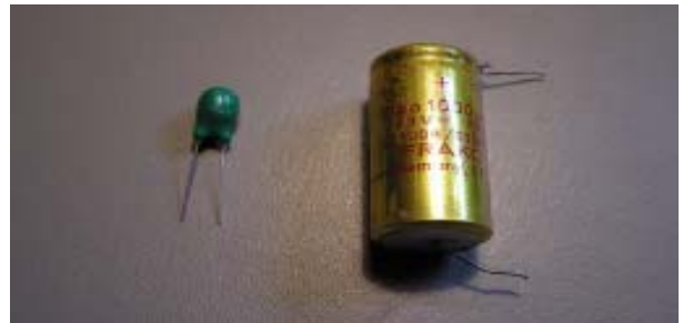
Bilden visar polariserade kondensatorer. De måste vändas rätt.
