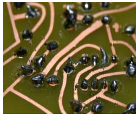
Här har lödkolven värmt upp lödställe och komponentben, och lödtennet har flutit ut ordentligt. Lödningen kommer att hålla i 20 år.
