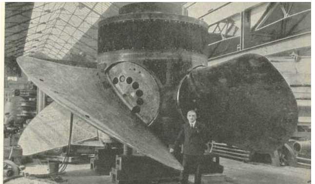
Kaplanturbin till svenskt vattenkraftverk. Vattnet kommer i en tunnel uppfifrån och skovlarnas vinkel kan ställas för maximalt varvtal. Notera mannen nederst i mitten. Dimensionerna är stora. En generator som genererar elström kopplas till turbinens axel.
