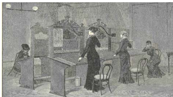
Sveriges första telefonväxel togs i bruk i Stockholm i början på 1880-talet. Den var manuellt betjänad.
