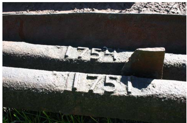
Gjutjärn, kallade "gösar" utanför Österby Vallonsmedja En gös vägde 300-400 kg och var 4 m lång
